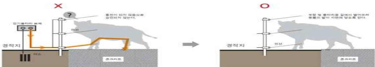
[그림 4-2] 전기울타리 바깥쪽이 콘크리트나 아스팔트로 포장되어 있는 경우
