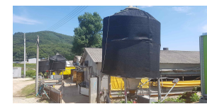
사료빈 차광막 설치
