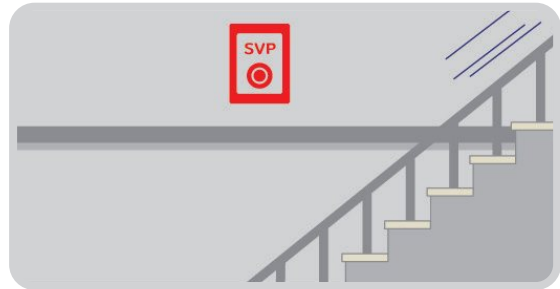
④ 스프링클러 수동조작스위치(SVP)는 피난계단 출입구 옆에 설치하세요.
