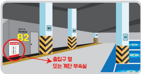
① 질식소화포, 상방향 살수장치는 출입구 옆에 두거나 계단 부속실에 보관한다.
